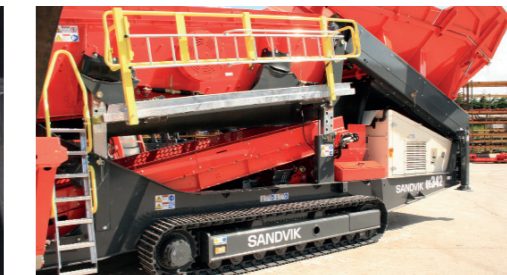
Dispositivo de elevación de la caja de cribado que permite el fácil acceso
