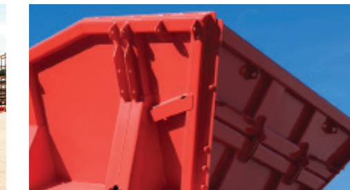
Puerta trasera de la tolva dividida para alimentación directa
