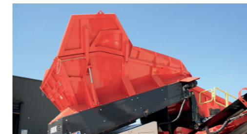
Tolva de una pieza mostrada con extensiones de tolva opcionales y bocas de salida en toda su longitud
